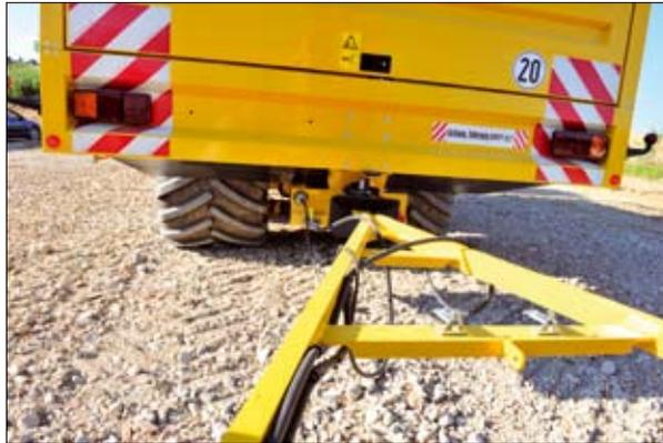
Verbinden Sie die beiden Bremsleitungen der Druckluft- Zweileitungsbremse wie folgt mit den Anschlüssen an der Maschine: Schließen Sie zuerst links die gelb gekennzeichnete Leitung an und danach erst rechts die rot gekennzeichnete Leitung.
