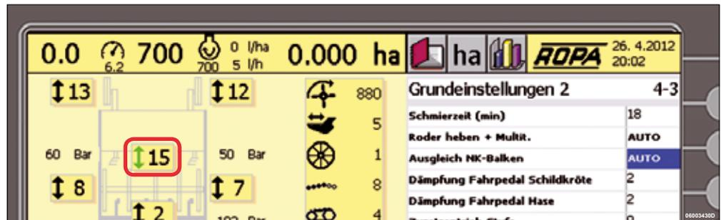
Wenn die Option „NEIN“ gewählt ist, ist die Schnittstärkenverstellung von der Höhenverstellung der Schleglerwelle abgekoppelt.
