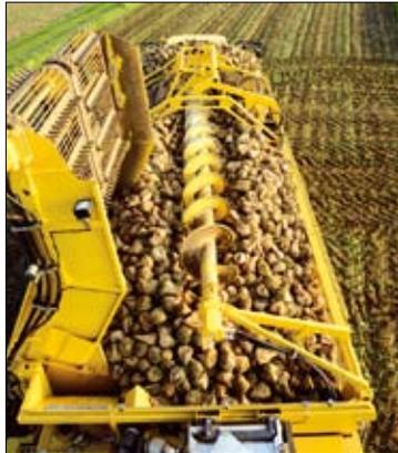
Das Umschalten der Bunkerschnecke erfolgt automatisch, gesteuert von einem Ultraschallsensor, der sich geschützt oben in der hinteren Bunkerwand befindet. Wird die Bunkerschnecke auf Förderrichtung nach vorne umgeschaltet, wird der Fahrer durch einen dreimaligen Piepton und durch das Blinken des Bunkersymbols im Terminal darüber informiert.
