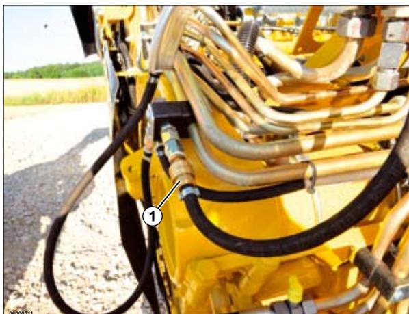
Unmittelbar vor dem Ankuppeln einer Hydraulikleitung sind alle Kupplungsflächen gründlich mit Reinigungsspray und Druckluft abzublasen und gegebenenfalls mit einem sauberen und fusselreiem Tuch zu reinigen, da es sonst zu Schäden im Hydrauliksystem kommen kann.
