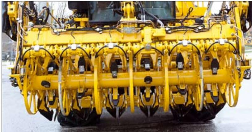
Der gesamte Roder (Rüttelschar, Paddel, Tastwalze, Rodewalzen, Zwickwalze) wird hydraulisch angetrieben.
