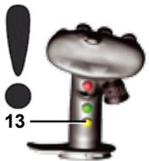
Wird vor dem Betätigen dieser Taste (6) die Taste (13) „Gas -“ gedrückt und in dieser Stellung festgehalten, ist die Einregelung auf die minimale Rodedrehzahl unterdrückt.
