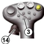
Der vorgewählte Schongang wird durch kurzen Druck auf Taster (3) am Joystick aktiviert. Voraussetzung dafür ist:
