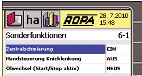
Nach dem Ablauf des eingestellten Schmierintervalls (18 Min.) schaltet die manuelle Schmierung wieder ab.
