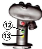
Das automotiv Roden kann jederzeit durch Drücken der Gas + (12) oder Gas - (13) Taste abgestellt werden. Die Drehzahlverstellung erfolgt dann manuell über die beiden Tasten. Werden diese beiden Tasten gleichzeitig gedrückt, ist das automotiv Roden wieder aktiviert.
