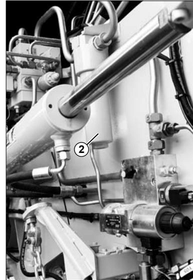
(2) Druckfilter Vorderachslenkung
