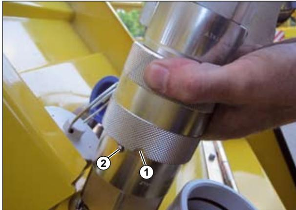
Reinigen Sie nach dem Trennen alle Kupplungsflächen und alle Blindverschlusskappen und Deckel mit Druckluft und Reinigungsspray und setzen Sie die Blinddeckel und Blindkappen wieder auf die zugehörigen Kupplungselemente.
