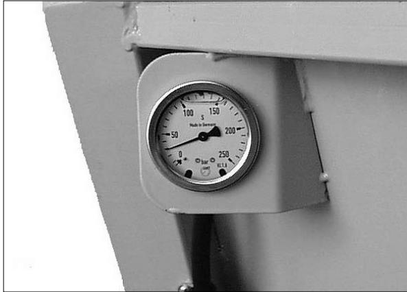
An der vorderen rechten Ecke der Bunkerwand befindet sich das Manometer mit der Anzeige des Drucks, mit dem die hintere (letzte) Achse von der automatischen Achslastregelung angesteuert wird. Das Manometer der Achslastregelung ist während der Arbeit mindestens einmal täglich zu kontrollieren.
