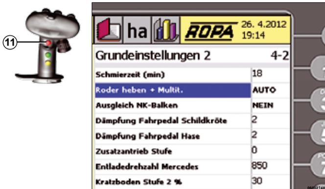
Wird bei fahrender Maschine vor dem Ausheben des Dreipunkts der Multitaster (11) gedrückt und fest gehalten, wird der Dreipunkt nur so lange gehoben, wie Sie den Mini-Joystick (1) zurückziehen. Die Unterdrückung der Aushebeautomatik ist immer dann die bessere Wahl, wenn der Acker quer zur Roderichtung von großen Furchen oder Rinnen durchzogen ist. In diesen Fällen ist es erfahrungsgemäß besser, die automatische Tiefenführung kurz zu unterbrechen, wenn diese Hindernisse überquert werden.
