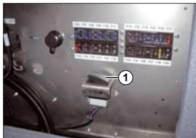
Dieser Override-Schalter verzögert zunächst die Reduzierung von Motordrehmoment und Motordrehzahl für die Dauer von 30 Minuten. Er kann maximal 3x gedrückt werden. Nach Ablauf der letzten 30-Minutenfrist sinkt die Motorleistung allerdings schlagartig auf 20% der Nennleistung bei gleichzeitiger Reduzierung der Motordrehzahl. Die LIM-Warnung erscheint nicht mehr.
