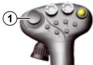
**(1) Mini-Joystick (1) vor/zurück** (Dreipunkt senken/ heben, nur bei laufendem Dieselmotor)
