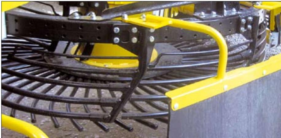
Die Außenroste des 2. und 3. Siebsterns sind vom Fahrersitz aus einstellbar. Wählen Sie dazu mit dem Drehwahlschalter am Bedienteil I die Position 8 aus.
