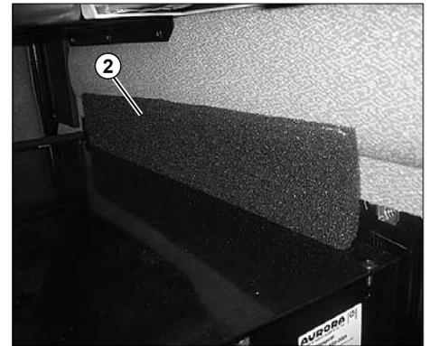
Dieser Filter sollte mindestens einmal jährlich mit Druckluft wie folgt gereinigt werden:
