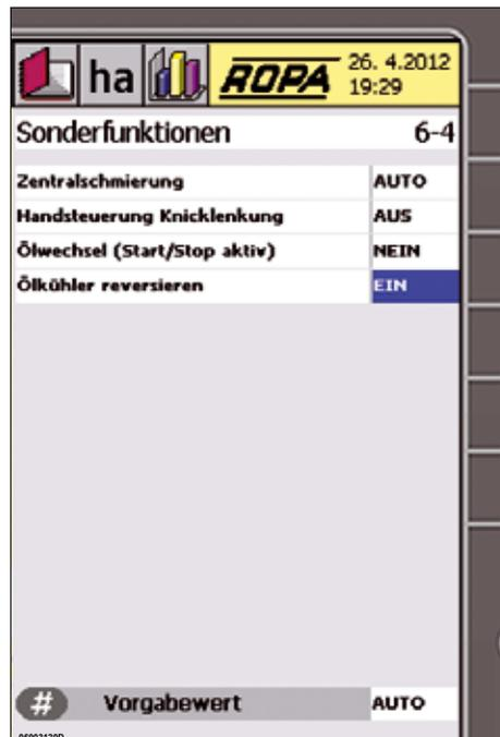
Der Lüfterantrieb des Hydraulikölkühlers reversiert in regelmäßigen Zeitabständen automatisch. Damit werden Verschmutzungen eigenständig weitgehend entfernt. Das manuelle Reversieren ist zusätzlich möglich. Rufen Sie dazu im Menü Sonderfunktionen die Zeile „Ölkühler reversieren“ auf und stellen Sie den vorgegebenen Wert auf EIN. Nach dem Bestätigen der Auswahl reversiert der Ölkühler für einen Zyklus.
