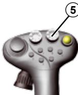
Wird der Kreuztaster nur kurz angetippt, erfolgt die Verstellung stufenweise um eine Stufe nach oben oder nach unten.
