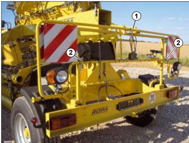
12) Bolzen (1) des Oberlenkers (2) am Rodeaggregat entsichern und herausziehen.
