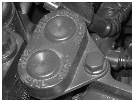
Von tritt- und standsicherer Leiter oder Staffelei aus den START- und den STOP-Taster am Motor für ca. 10 Sekunden gleichzeitig drücken. Während dieser Zeit dreht der Motor ohne Last und ohne anzuspringen. Motorhaus schließen. Sobald die Zündung abgeschaltet wird oder der Motor gestartet wird, stellt sich die Einstellung „Ölwechsel START/STOP aktiv“ automatisch auf Standardwert zurück. Danach Motor vom Fahrersitz aus starten und ohne Gas ca. eine Minute laufen lassen. Dann Motor abstellen.
