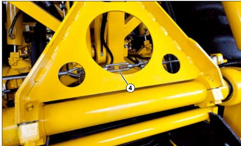
Die Höhenposition des Siebbandes zur letzten Rodewalze kann mit Hilfe des Spannschlusses (4) am Aufhängeseil eingestellt werden. Das Band sollte grundsätzlich so hoch wie möglich eingestellt werden, um unter dem Band Platz für abgereinigtes Erdreich zu erhalten.
