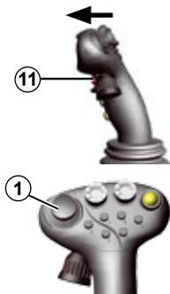
Soll der Schlegler manuell angehoben werden ohne gleichzeitig das Rodeaggregat zu heben, halten Sie den Multitaster (11) gedrückt und ziehen Sie den Joystick nach hinten. Dabei wird der Schlegler von den Schleglerentlastungszyindern maximal angehoben. Sobald sie den Mini-Joystick (1) kurz nach vorne schieben, wird die Zusatzaushebung abgeschaltet. Gleichzeitig wird die Entlastungsdruckregelung der Schleglerentlastungszyindern aktiviert und der ursprüngliche Entlastungsdruck eingeregelt.
