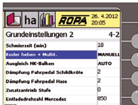
Wird vor dem Ausheben des Dreipunkts der Multitaster (11) gedrückt und festgehalten bis das Rodeaggregat beliebig weit ausgehoben wird, unterdrücken Sie die Abschaltautomatik. Der Maschinenantrieb läuft während des Aushebens weiter. Die Unterdrückung der Abschaltautomatik ist dann sinnvoll, wenn bei sehr ungünstigen Bodenverhältnissen (z. B. im Vorgewende) die Möglichkeit besteht, dass die Siebsterne Bodenkontakt bekommen können.
