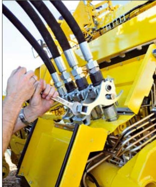
Verriegeln Sie die Schnellkuppler der Hydraulikschläuche vollständig. Prüfen Sie, ob die federbelasteten Sicherungsbleche (1) vollständig eingerastet sind. Danach schließen Sie die Abdeckung der Hydraulik-Schnellkuppler.
