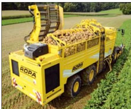
Im Bunker befindet sich die Bunkerschnecke. Mit dieser Förderschnecke werden die Zuckerrüben gleichmäßig im Bunker verteilt. Die Bunkerschnecke kann vorne und hinten separat abgesenkt oder angehoben werden. Die Bunkerschnecke fördert zunächst die Rüben nach hinten.
