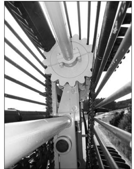
Prüfen Sie die Antriebsräder mindestens einmal pro Saison in dem mit einem Pfeil markierten Bereich auf Verschleiß. Stark verschlissene Antriebsräder führen zum vorzeitigen Bruch der Nietstäbe.
