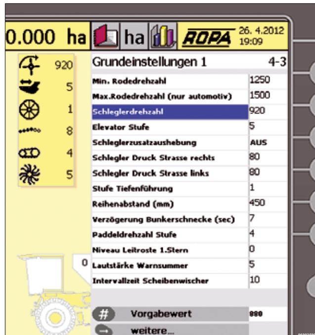
Empfohlene Schleglerwellendrehzahl:    PBSh                    800 - 900 min<sup>-1</sup>
