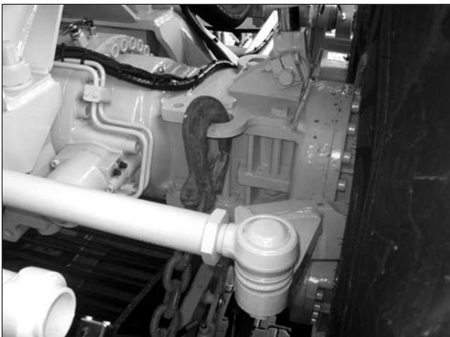
*Verzurröse an der Vorderachse rechts (hinten)*
