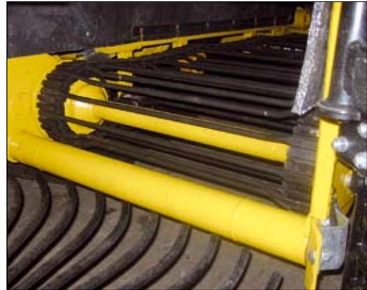
Zum Einstellen der Siebband-Höhe hinten zunächst beide Muttern (2) auf der Gewindestange (1) lösen. Danach Muttern (2) so weit verdrehen, dass sich weder Siebsternzinken und Siebband noch Siebsternzinken und Siebbandgetriebe während des Betriebes berühren.
