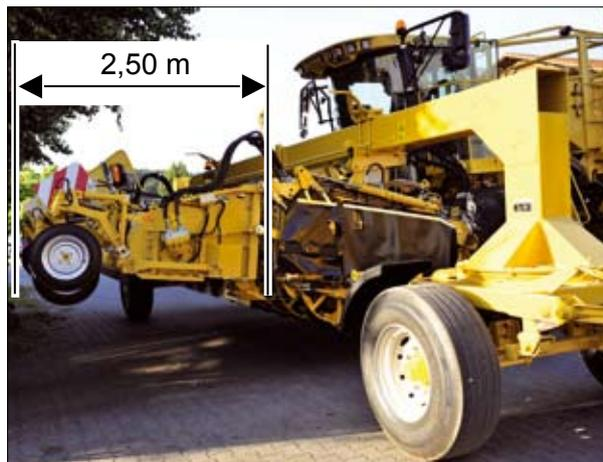
Bei nicht ganz ebenem Gelände sollten Sie eine Fläche suchen, auf der sich der Transportwagen maximal leicht (Gefälle nicht über  $3^\circ$ ) zur Maschine neigt. Neigt sich der Transportwagen von der Maschine weg, ist das Ankoppeln kaum möglich.
