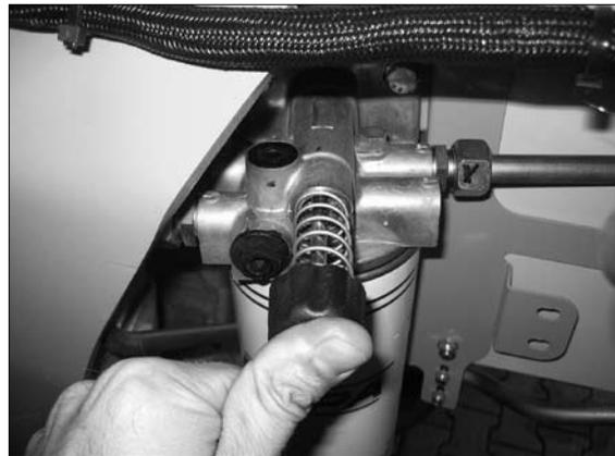
*Standard-Vorfilter mit Kolbenpumpe*
