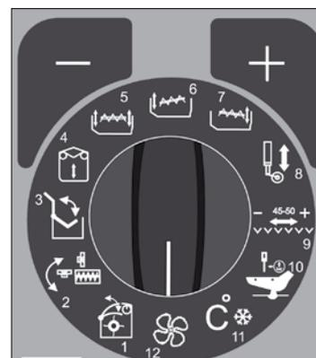
Das Einstellen der Gebläsedrehzahl erfolgt über die **+** und **-** Tasten am Bedienteil II. Wählen Sie dazu mit dem Drehwahlschalter Position 12 aus.
