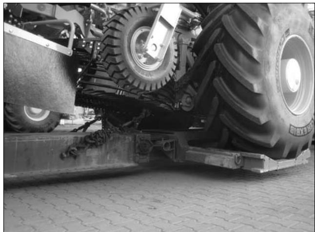
*Verzurrung der Vorderachse am Tieflader mit Spannketten*
