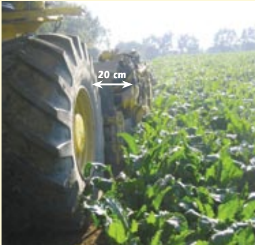
Verschieben der Schlegler-Rodereinheit links / rechts
