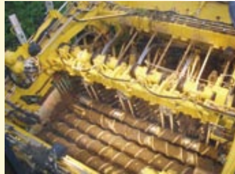
Verschieben der Schlegler-Rodereinheit links / rechts
