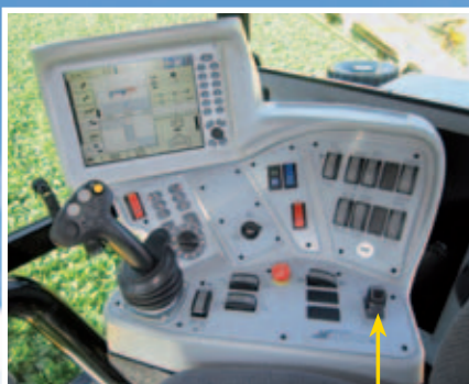
multifunkční terminál pouze jedním ovladačem se automaticky rozkládá i skládá
