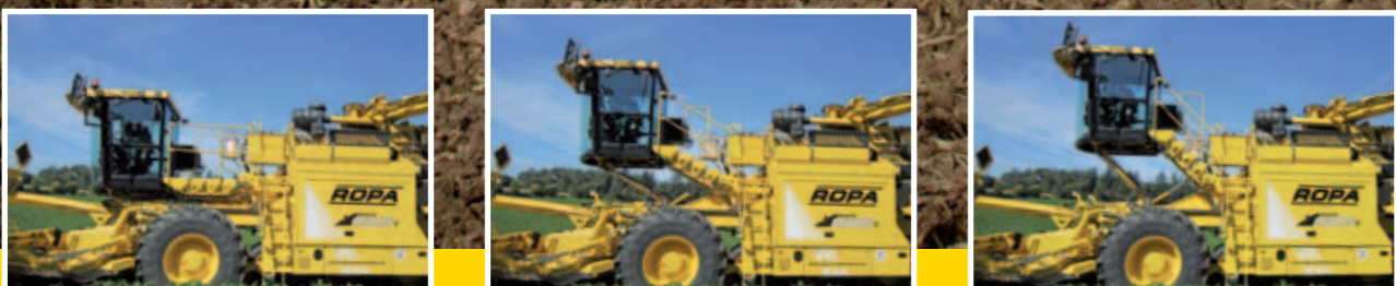
zvedací komfortní kabina - plošina se mění ve schůdky
