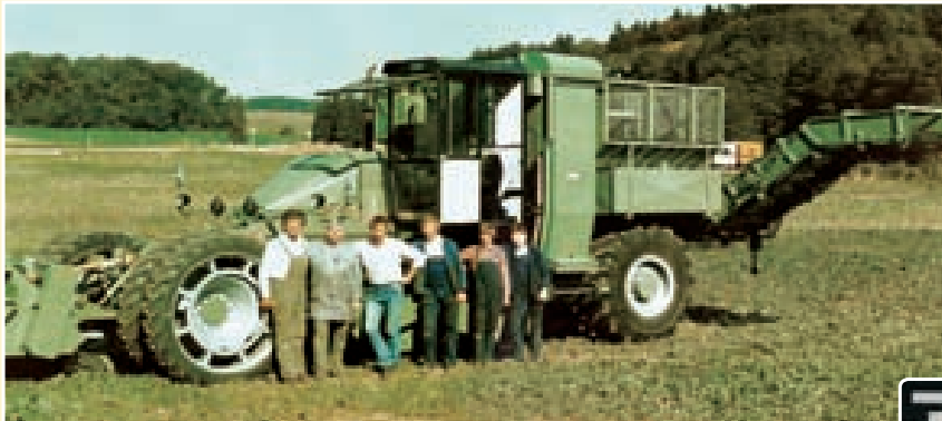
Erster Ropa-Vollernter mit kleinem Zwischenbunker
