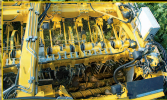
отличный обзор копителя -> Комбайнер видит рядки свеклы и работу Micro-Topper
