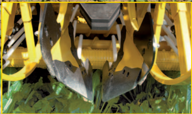
подкапывающие лемехи ROPA для наиболее бережного обращения со свеклой. Угол и расстояние между лемехами оптимально настраивается в 6 позиций.
