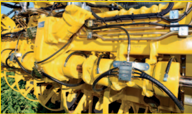
Brži oscilatorni raonik pogonjen linijskim klipnim motorom i konusnim zupčanicom, podesivi ležajevi sa konusnim valjcima
