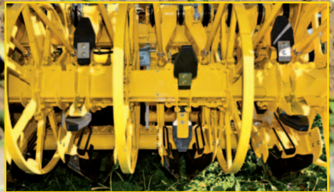
Točkovi kontrole dubine sa promenljivom širinom reda 45/50 cm, podesiv iz kabine pritiskom na dugme
