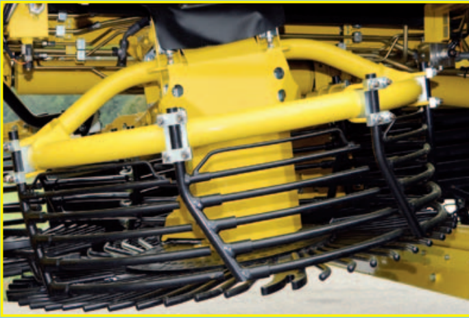
Grilles droites avec des réglages fins en hauteur, inclinaison et angle, échangeables par tronçon
