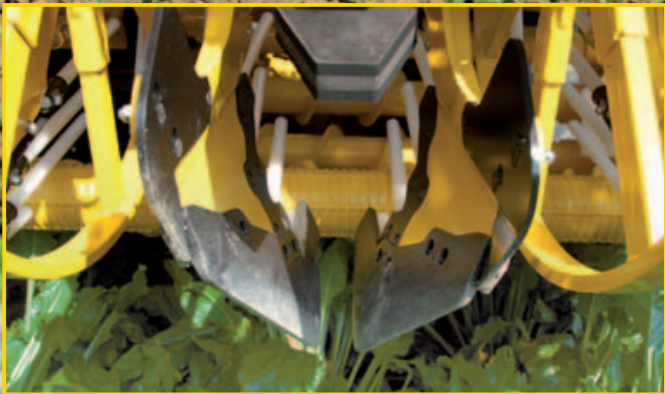
Socs ROPA pour un meilleur traitement de la betterave l'angle et l'écartement des socs peuvent être réglés de façon optimal dans 6 positions
