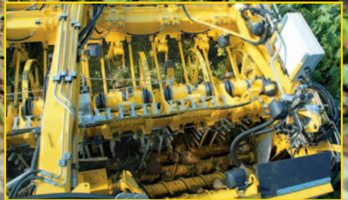
Très bonne visibilité sur le bâti -> Le chauffeur a une visibilité sur le rang de betteraves et sur l'effet du scalpage par les Micro-Topper
