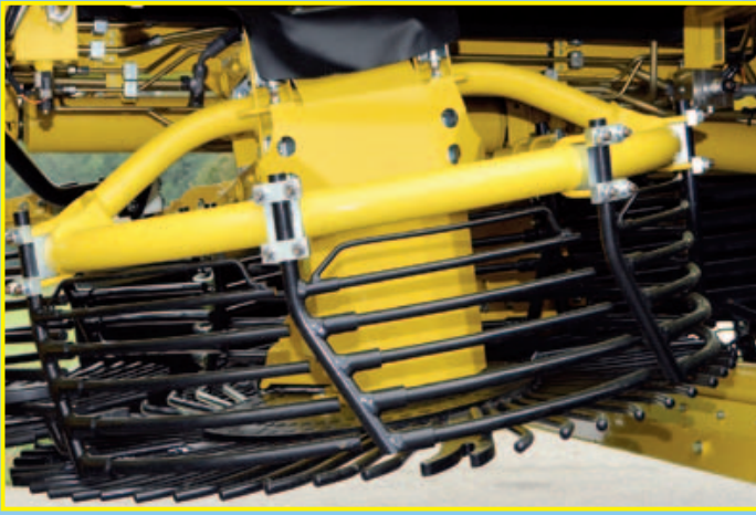
Siebsterne in Höhe, Neigung und Drehung einzeln fein justierbar und segmentweise austauschbar
