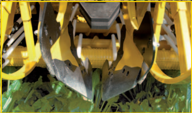
ROPA Rodeschare für bestmögliche Rübenschonung Scharwinkel und Scharabstand können in sechs Positionen optimal angepasst werden.
