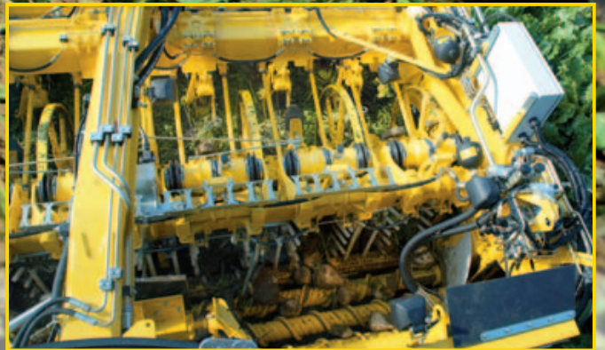
Sehr gute Einsicht in das Rodeaggregat -> Der Fahrer sieht die Rübenreihe und das Köpfergebnis der Micro-Topper
