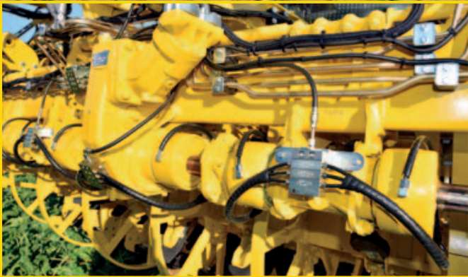
Schnellerer Rüttelscharantrieb mit Axialkolbenmotor und Stirnradgetriebe, nachstellbare Kegelrollenlager
