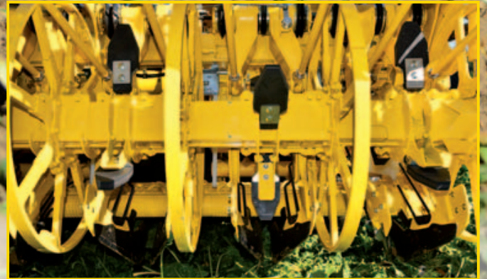
Tastwalze mit variabler Reihenweite 45/50 cm, verschiebbar per Knopfdruck aus der Kabine
