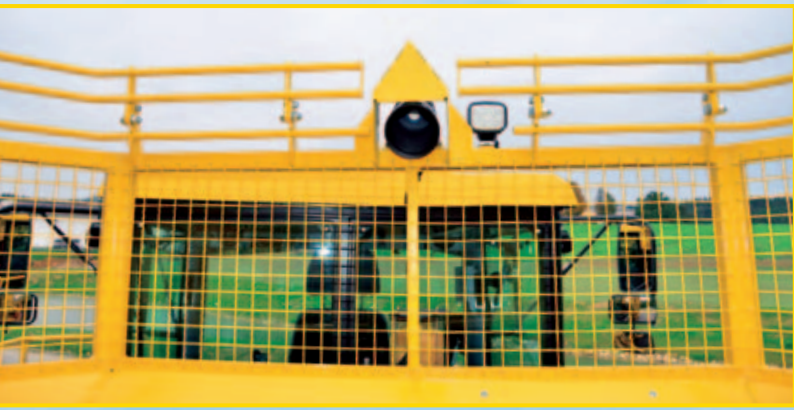
Ertragsfassung über Ultraschallsensoren und Bunkerfüllstandsmessung
