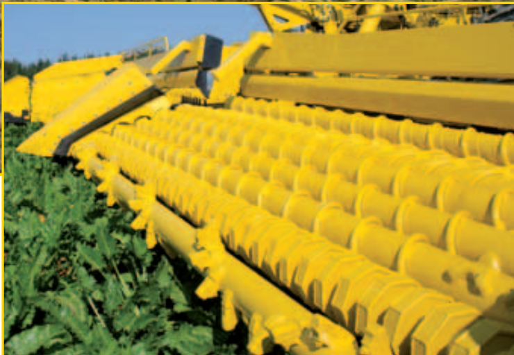
Separate Antriebe für 3 Walzengruppen mit individueller Drehzahlanpassung und automatischer Reversierung bei Steinklemmer
