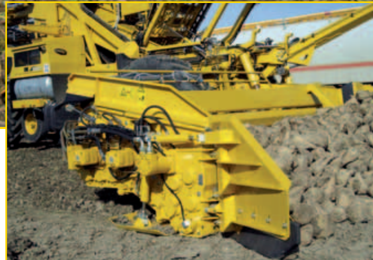
Separate Antriebe für 3 Walzengruppen mit individueller Drehzahlanpassung und automatischer Reversierung bei Steinklemmer
