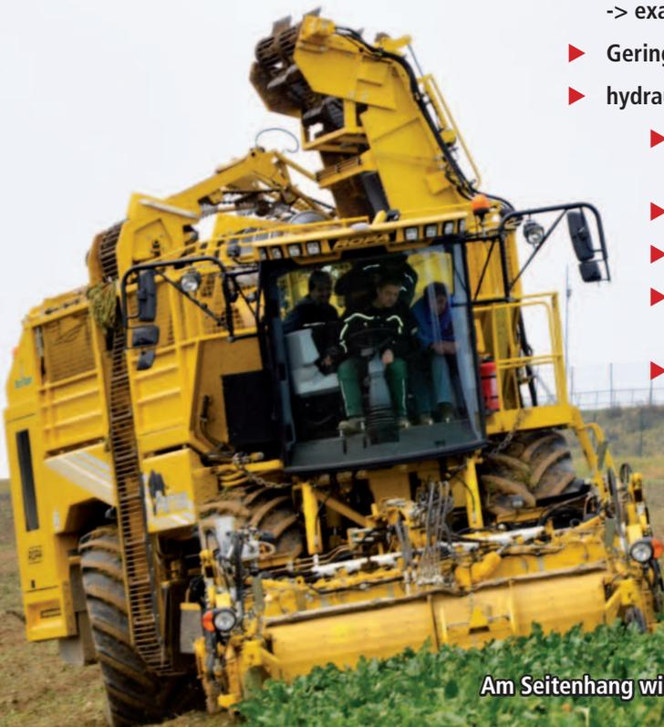
Am Seitenhang wird das Chassis um bis zu 5 Grad zum Hang hin geneigt.
